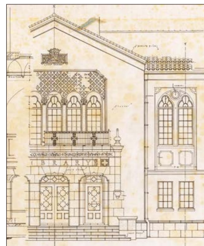
1927年に描かれた時計台(当時は図書館)の玄関・外壁詳細図。細部まで丁寧に書き込まれた意匠は、大部分が現代に受け継がれている(一粒社ヴォーリス建築事務所 所蔵)
